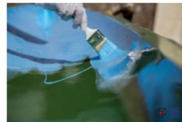
voskom kako se plastika ne bi zalijepila u kalup. Nakon mazanja voskom, u kalup je nanesen gelcoat premaz u plavo - bijeloj boji koji je ostavljen da se potpuno osuši i otvrde.
