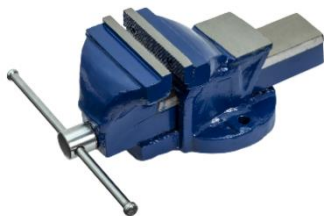
Slika 1 – bravarski škripac čeljusti 100 mm
