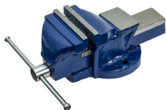
Slika 1. Bravarski škripac čeljusti 100 mm
