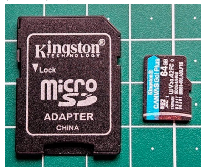
Slika 1.7. Lijevo – adapter za microSD -karticu, desno – microSD -kartica
