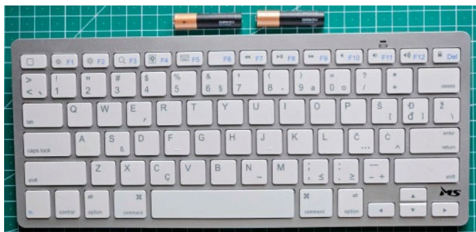
Slika 1.11. Ovo je bluetooth tipkovnica s HR-rasporedom tipki koja se napaja s dvije baterije od 1,5 V tipa AAA
