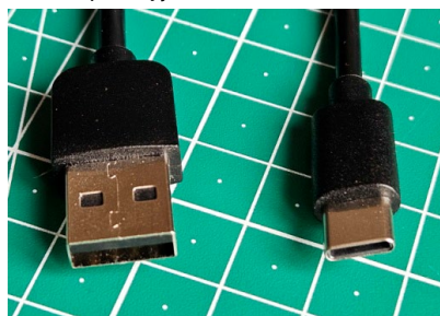
Slika 1.6. Lijevo – kabel s USB-konektorom, desno kabel s USB-C-konektorom
