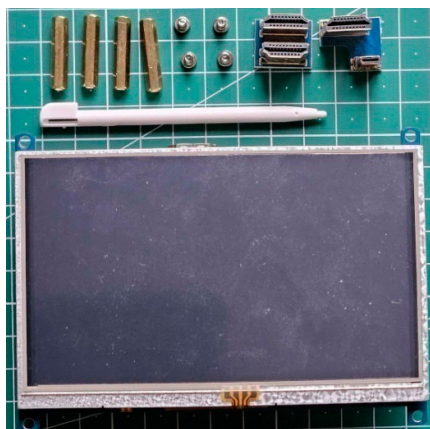
Slika 1.9. Izabran je zaslon od 5 inča, osjetljiv na dodir. U kompletu se dobivaju: četiri cjevčice s navojem i četiri vijka za direktno spajanje na pločicu Raspberryja, dva para prilagođenih HDMI-konektora za izravno spajanje bez kabela (onaj veći je za Pi 3, a drugi za Pi 4 ili Pi 5) i jedna pisalica za preciznije tapkanje po zaslonu
