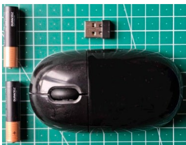
Slika 1.12. Za napajanje bežičnog miša potrebne su dvije baterije od 1,5 V tipa AAA. Uz njega ide i bluetooth -adapter koji valja priključiti na jedan od četiriju USB-konektora na pločici Raspberryja
