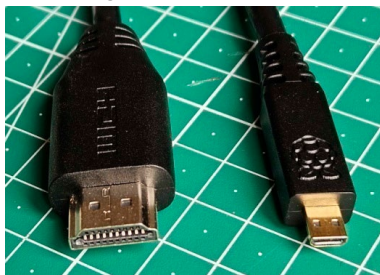
Slika 1.4. Lijevo – kabel s HDMI-konektorom, desno – kabel s microHDMI -konektorom
