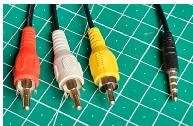
Slika 1.5. Slijeva nadesno, Cinch -konektori, crveni je za desni audiokanal, bijeli je za lijevi audiokanal, a žuti je za kompozitni videosignal. Desna strana fotografije, 3,5 mm TRRS jack
