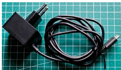
Slika 1.15. Originalni Raspberry Pi Power Supply 5,1 V / 3 A
