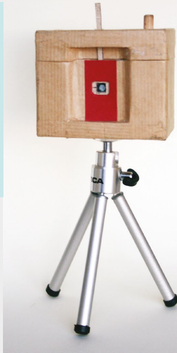
Fotografija br. 2, Cameru obscuru MRAVICA M napravio sam od kartona i ona snima na fil lajka formata.
