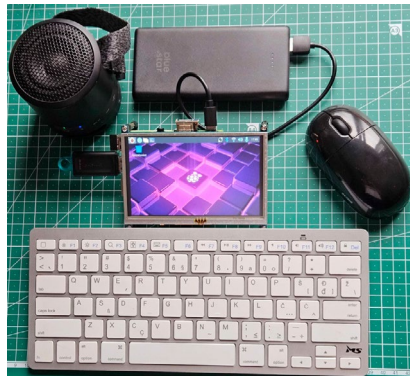
Slika 1.16. Ova konfiguracija iziskuje samo jedan kabel, onaj za napajanje. Raspberry Pi se na fotografiji ne vidi jer je spojen ispod zaslona
