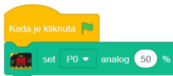
Slika 58.15. Programski blok koji omogućava paljenje i gašenje LED-ice velikom brzinom (vrlo kratak period) s radnim ciklusom 50 %
