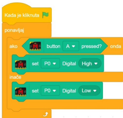
Slika 58.8. Programski kôd za paljenje i gašenje LED-ice
