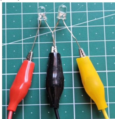
Slika 58.12. Kraće izvođe LED-ica međusobno namotajte frkanjem te ih crnom spojnom žicom spojite na GND
