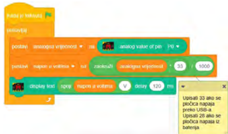
Slika 60.7. Programski kôd koji čita vrijednosti na pinu P0 te ih nakon preostrojanja prikazuje u voltima na displeju BBC micro:bita
