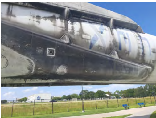
Slika 8. Detalj nogu za stabilizaciju Izvor: Privatna kolekcija Z. Pelagića
