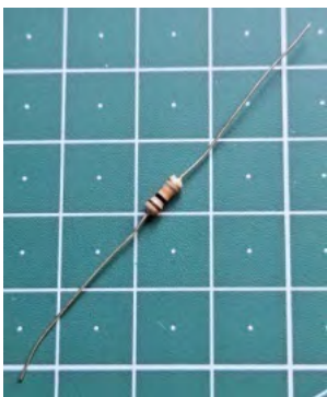
Slika 60.4. Otpornik od 10 000 \Omega ima prstene u sljedećim bojama, smeđa – crna – narančasta – zlatna
