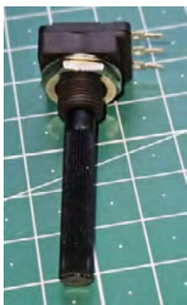
Slika 60.13. Potencijometar koji ćete trebati između vanjskih izvoda ima otpor od 10 000 Ω. Na njegovom kućištu piše oznaka 10k
