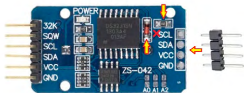
Slika 10. Modifikacija modula ZS-042
