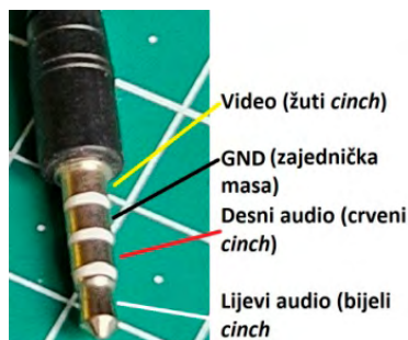
Slika 2.16. Fotografija prikazuje raspored pinova na 3,5 mm jacku za videokompozitni i stereofonski audiosignal na Raspberryju
