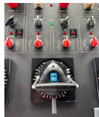
Upravljačka konzola za Azipod na navigacijskom mostu broda (osobni album)
