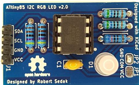
Slika 78. Dvije izvedbe I2C slave modula s RGB-diodom, izrađene prema shemama sa Slike 77.
