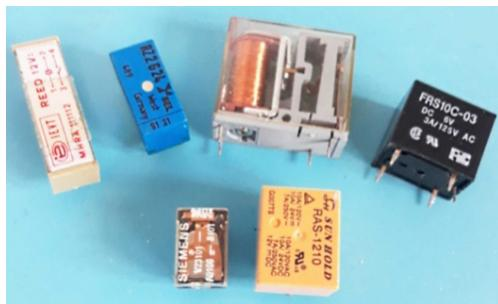
Slika 29.17. Fotografija prikazuje nekoliko različitih modela releja. Uočite zavojnicu kod releja s prozirnim kućištem
