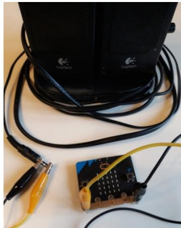
**Slika 34.4.** Zvučnike s pojačalom spojite preko krokodil-štipealjki na pločicu BBC micro:bita s GND i P0. Priklučak za zvučnike je stereo pa će njegov središnji kontakt ostati sloboden
