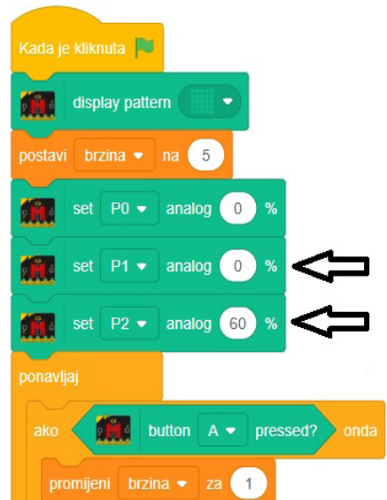
Slika 59.19. Unutar prijašnjeg programa dodajte dva bloka, "set P1 analog 0 %" i "set P2 analog 60 %"
