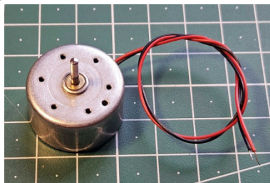
Slika 59.2. Minielektromotor skinut sa zastarjelog CD-pogona, otpisanog starog kompjutera
