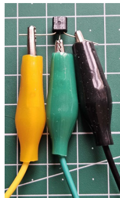
Slika 59.10. Tranzistor je malen pa si olakšajte spajanje savijanjem njegovih izvoda
