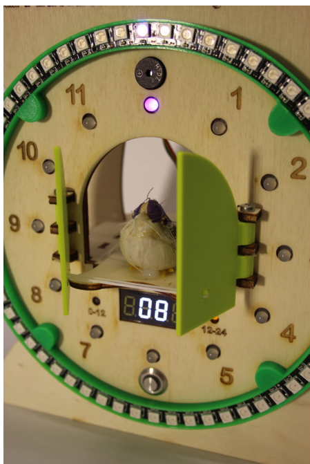
Slika 10. Elektronika je smještena u kućište od šperploče
