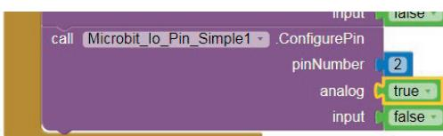
Slika 18.1. U bloku "call Microbit\_Io\_Pin\_Simple1 .ConfigurePin" kod "analog" upišite "true"
