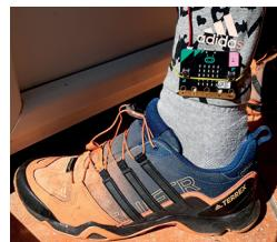
Slika 18.12. Pločicu BBC micro:bita i pripadajuću bateriju omotajte elastičnom gumicom oko gležnja
