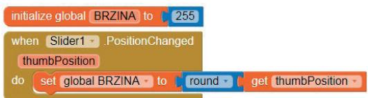
Slika 18.2. Imenujte novu promjenljivu "BRZINA" te dodajte blok "when Slider1. PositionChanged do..." koji će promjenjivu puniti brojevima od 0 do 255
