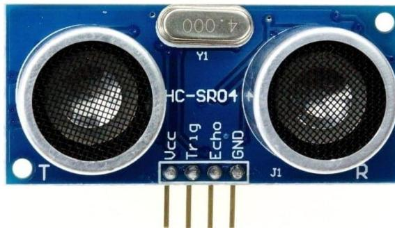
Ako želimo jednostavno izmjeriti neku udaljenost, a preciznost nam nije toliko važna i usto ne želimo potrošiti previše novaca, **HC-SR04 ultrazvučni senzor udaljenosti** je idealan odabir. Ovaj se senzor najčešće koristi kao senzor za otkrivanje prepreka i njihovo izbjegavanje.
