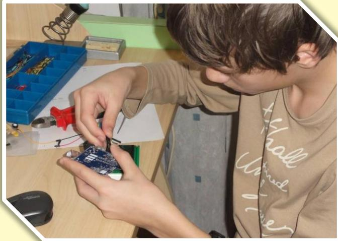
Pričvrstio sam magnet i HAL senzor, pa sam spojio senzor na Arduino i počeo programirati. Kad je proradio, zalemio sam pinove na LCD ekran i pričvrstio ga na eksperimentalnu pločicu.
