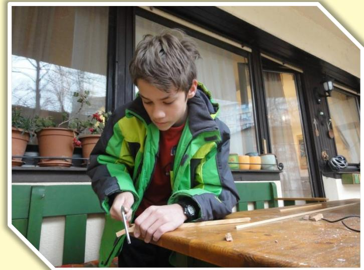
*Prvo sam napravio nacrt u programu za 3D modeliranje SketchUp, a zatim sam ispilio sve dijelove. Šperploču sam pilio sa Unimatom (mala motorna pilica), a letvice sa običnom ručnom pilom.*
