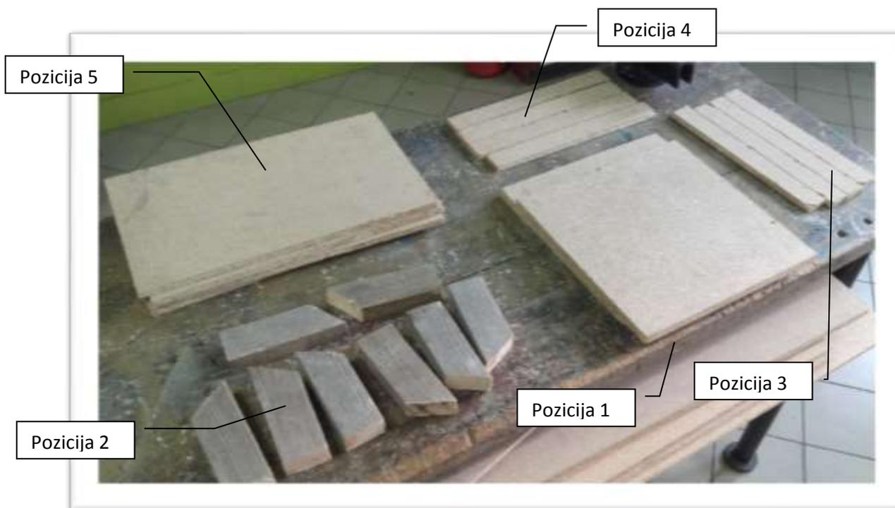
Pozicije smo međusobno lijepili ljepljivom za drvo (drvofix) i vijcima kako bi spoj bio čvršći i dugotrajniji. Ocrtili smo mjesta bušenja i označili ih šilom. Provrt smo napravili pomoću stolne bušilice i svrdla  $\varnothing 3$ . Broj potrebnih vijaka za spojeve odredili smo nasumično (2-3 vijka za svaku poziciju).
