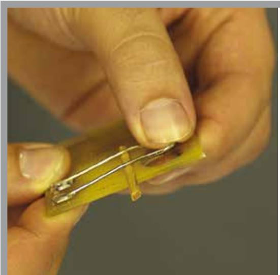
Zalemljenu spajalicu pažljivo malo podignite i ispod nje stavite drveni štapić na oznaku "ovdje saviti".
