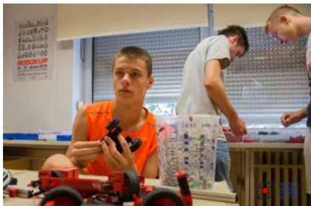
funkcionalna robotska kolica. Na postojeće vozilo ugradili su dodatni sklop koji se sastoji od senzora za praćenje crte, UZV senzora, sučelja i baterije ( 8,4 V). Spojili su sve spomenute elemente sa sučeljem i izvorom napajanja (baterijom). Nakon izvršene provjere funkcionalnosti spojenih elemenata u programu RoboPro, napisali su program za kontrolu rada elektromotora i postavljenih senzora. Program je prenesen na memoriju sučelja, čime je ostvarena potpuna autonomija robotskih kolica.
